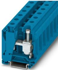
Borne de paso, tensión nominal: 1000 V, corriente nominal: 125 A, número de conexiones: 2, tipo de conexión: Conexión por tornillo, Sección de dimensionamiento: 35 mm<sup>2</sup>, sección: 10 mm<sup>2</sup> - 35 mm<sup>2</sup>, clase de montaje: NS 35/7,5, NS 35/15, color: azul
