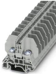
Borne de paso con técnica de conexión por pernos, sección 0,1 - 10 mm<sup>2</sup>, AWG: 26 - 8, ancho 13 mm, color: gris
