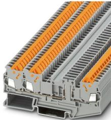
Borna seccionable, tensión nominal: 400 V, corriente nominal: 17,5 A, número de conexiones: 3, tipo de conexión: Conexión rápida, Sección de dimensionamiento: 1,5 mm<sup>2</sup>, 1er piso, sección: 0,25 mm<sup>2</sup> - 1,5 mm<sup>2</sup>, clase de montaje: NS 35/7,5, NS 35/15, color: gris
