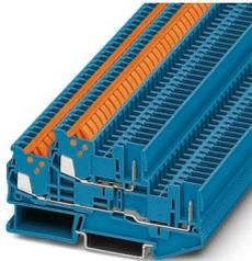
Borna de doble piso, La corriente y la tensión son determinadas por el conector empleado., tensión nominal: 500 V, corriente nominal: 17,5 A, tipo de conexión: Conexión rápida / conexión enchufable, Sección de dimensionamiento: 1,5 mm<sup>2</sup>, sección: 0,25 mm<sup>2</sup> - 1,5 mm<sup>2</sup>, montaje: NS 35/7,5, NS 35/15, color: azul
