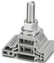
Conectores de corriente de alta intensidad, tensión nominal: 1000 V, corriente nominal: 269 A, número de conexiones: 1, tipo de conexión: Conexión por espárrago, Sección de dimensionamiento: 120 mm<sup>2</sup>, clase de montaje: NS 35/7,5, NS 35/15, color: gris
