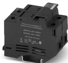
Borne de carril para fusible, tipo de fusible: Vidrio/cerámica/..., tipo de fusible: Class CC, tensión nominal: 600 V, corriente nominal: 30 A, número de polos: 2, tipo de conexión: Conexión por tornillo, Sección de dimensionamiento: 16 mm<sup>2</sup>, sección: 1 mm<sup>2</sup>- 16 mm<sup>2</sup>, clase de montaje: NS 35/7,5, NS 35/15, color: negro
