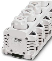
Borne de carril para fusible, tipo de fusible: Cartucho de fusible roscado, tipo de fusible: D II / E 27, tensión nominal: 500 V, corriente nominal: 25 A, tipo de conexión: Conexión por tornillo, Sección de dimensionamiento: 35 mm<sup>2</sup>, sección: 1,5 mm<sup>2</sup>- 35 mm<sup>2</sup>, clase de montaje: NS 35/7,5, NS 35/15, color: gris claro
