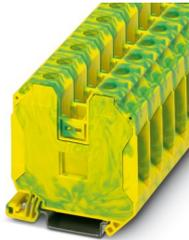
Borna de tierra, Con tornillos hexagonales interiores, tensión nominal: 500 V, corriente nominal: 17,5 A, número de conexiones: 2, tipo de conexión: Conexión por tornillo, Sección de dimensionamiento: 35 mm<sup>2</sup>, sección: 1,5 mm<sup>2</sup> - 35 mm<sup>2</sup>, clase de montaje: NS 35/7,5, NS 35/15, color: amarillo-verde
