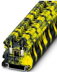
Borne de paso, tensión nominal: 1000 V, corriente nominal: 32 A, número de conexiones: 2, número de polos: 1, tipo de conexión: Conexión por tornillo, sección: 0,14 mm<sup>2</sup> - 6 mm<sup>2</sup>, clase de montaje: NS 35/7,5, NS 35/15, color: negro/amarillo
