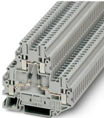
Borne para componentes, La corriente máx. queda determinada por el diodo. Montado: diodo 1N 4007, tensión inversa: 1300 V, corriente límite constante: 0,5 A., con diodo integrado, corriente nominal: 0,5 A, tipo de conexión: Conexión por tornillo, 1er y 2º piso, Sección de dimensionamiento: 2,5 mm<sup>2</sup>, sección: 0,14 mm<sup>2</sup> - 4 mm<sup>2</sup>, clase de montaje: NS 35/7,5, NS 35/15, color: gris
