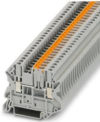
Borne interrumpible por cuchilla, con cuchilla seccionadora girada 180°, tipo de conexión: conexión por tornillo, sección: 0,14 mm<sup>2</sup> - 4 mm<sup>2</sup>, AWG: 26 - 12, ancho: 5,2 mm, color: gris, tipo de montaje: NS 35/7,5, NS 35/15
