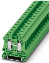
Borne de paso, tensión nominal: 1000 V, corriente nominal: 57 A, número de conexiones: 2, tipo de conexión: Conexión por tornillo, Sección de dimensionamiento: 10 mm<sup>2</sup>, sección: 0,5 mm<sup>2</sup> - 16 mm<sup>2</sup>, clase de montaje: NS 35/7,5, NS 35/15, color: verde
