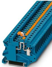
Borna interrumpible por cuchilla, con hembras roscadas para tomas de prueba para alojar clavijas de prueba, tensión nominal: 500 V, Corriente constante térmica  $I_{th}$ : 20 A, tipo de conexión: Conexión por tornillo, Sección de dimensionamiento: 4 mm<sup>2</sup>, sección: 0,14 mm<sup>2</sup> - 6 mm<sup>2</sup>, montaje: NS 35/7,5, NS 35/15, color: azul
