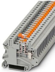
Borna interrumpible por cuchilla, tensión nominal: 500 V, Corriente constante térmica  $I_{th}$ : 20 A, tipo de conexión: Conexión por tornillo, Sección de dimensionamiento: 4 mm<sup>2</sup>, sección: 0,14 mm<sup>2</sup> - 6 mm<sup>2</sup>, montaje: NS 35/7,5, NS 35/15, color: gris
