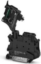
Borne de carril para fusible, tipo de fusible: Vidrio/cerámica/..., tipo de fusible: G/5 x 20, tensión nominal: 60 V, corriente nominal: 6,3 A, tipo de conexión: Conexión por tornillo, Sección de dimensionamiento: 4 mm<sup>2</sup>, sección: 0,14 mm<sup>2</sup>- 6 mm<sup>2</sup>, clase de montaje: NS 35/7,5, NS 35/15, color: negro
