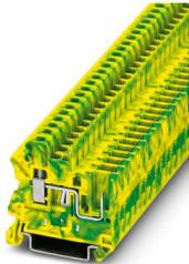
Borna de tierra, La corriente y la tensión son determinadas por el conector empleado., número de conexiones: 2, tipo de conexión: Conexión por tornillo / conexión enchufable, sección: 0,14 mm<sup>2</sup> - 6 mm<sup>2</sup>, clase de montaje: NS 35/7,5, NS 35/15, color: amarillo-verde
