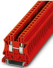
Borne de paso, tensión nominal: 1000 V, corriente nominal: 41 A, número de conexiones: 2, tipo de conexión: Conexión por tornillo, Sección de dimensionamiento: 6 mm<sup>2</sup>, sección: 0,2 mm<sup>2</sup> - 10 mm<sup>2</sup>, clase de montaje: NS 35/7,5, NS 35/15, color: rojo
