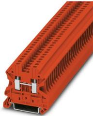
Borne de paso, tensión nominal: 1000 V, corriente nominal: 24 A, número de conexiones: 2, tipo de conexión: Conexión por tornillo, Sección de dimensionamiento: 2,5 mm<sup>2</sup>, sección: 0,14 mm<sup>2</sup> - 4 mm<sup>2</sup>, clase de montaje: NS 35/7,5, NS 35/15, color: rojo
