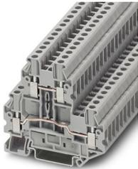
Borna de doble piso, tensión nominal: 500 V, corriente nominal: 24 A, tipo de conexión: Conexión por tornillo, Sección de dimensionamiento: 2,5 mm<sup>2</sup>, sección: 0,14 mm<sup>2</sup> - 4 mm<sup>2</sup>, clase de montaje: NS 35/7,5, NS 35/15, color: gris
