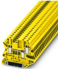
Borne de paso, tensión nominal: 500 V, corriente nominal: 32 A, número de conexiones: 3, tipo de conexión: Conexión por tornillo, Sección de dimensionamiento: 4 mm<sup>2</sup>, sección: 0,14 mm<sup>2</sup> - 6 mm<sup>2</sup>, clase de montaje: NS 35/7,5, NS 35/15, color: amarillo
