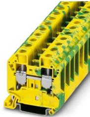
Borna de tierra, número de conexiones: 2, tipo de conexión: Conexión por tornillo, Sección de dimensionamiento: 16 mm<sup>2</sup>, sección: 1,5 mm<sup>2</sup> - 25 mm<sup>2</sup>, clase de montaje: NS 35/7,5, NS 35/15, color: amarillo-verde
