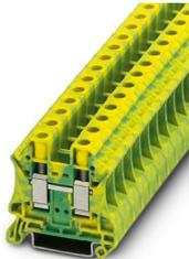
Borna de tierra, número de conexiones: 2, tipo de conexión: Conexión por tornillo, Sección de dimensionamiento: 10 mm<sup>2</sup>, sección: 0,5 mm<sup>2</sup> - 16 mm<sup>2</sup>, clase de montaje: NS 35/7,5, NS 35/15, color: amarillo-verde
