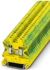
Borna de tierra, número de conexiones: 2, tipo de conexión: Conexión por tornillo, Sección de dimensionamiento: 2,5 mm<sup>2</sup>, sección: 0,14 mm<sup>2</sup> - 4 mm<sup>2</sup>, clase de montaje: NS 35/7,5, NS 35/15, color: amarillo-verde
