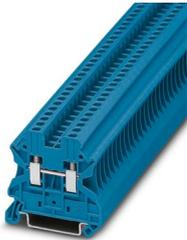
Borne de paso, tensión nominal: 1000 V, corriente nominal: 24 A, número de conexiones: 2, tipo de conexión: Conexión por tornillo, Sección de dimensionamiento: 2,5 mm<sup>2</sup>, sección: 0,14 mm<sup>2</sup> - 4 mm<sup>2</sup>, clase de montaje: NS 35/7,5, NS 35/15, color: azul
