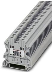
Borne de paso, tensión nominal: 1000 V, corriente nominal: 24 A, número de conexiones: 2, tipo de conexión: Conexión por tornillo, Sección de dimensionamiento: 2,5 mm<sup>2</sup>, sección: 0,14 mm<sup>2</sup> - 4 mm<sup>2</sup>, clase de montaje: NS 35/7,5, NS 35/15, color: gris
