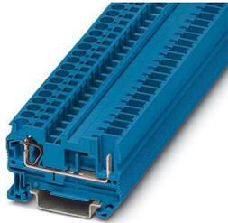
Borne de paso, tensión nominal: 800 V, corriente nominal: 32 A, número de conexiones: 2, tipo de conexión: Conexión por resorte / conexión enchufable, Sección de dimensionamiento: 4 mm<sup>2</sup>, 1er piso, conexión a la izquierda, sección: 0,08 mm<sup>2</sup> - 6 mm<sup>2</sup>, 1er piso, conexión a la derecha, clase de montaje: NS 35/7,5, NS 35/15, color: azul
