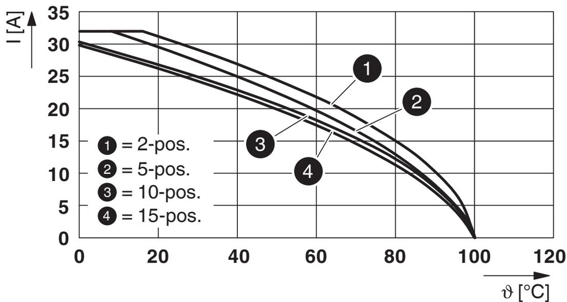
Curva derating para los bornes de resorte ST 4/1P.. y ST 4/2P.. con todas las variantes de conector SP 4/... . Las curvas derating se determinan multiplicando los valores de las curvas de base con el factor 0,8.
