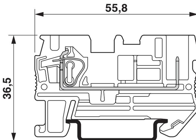
La figura muestra el borne con la variante de conector SP 4/...
