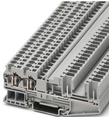
Borne de paso, tensión nominal: 800 V, corriente nominal: 32 A, número de conexiones: 4, tipo de conexión: Conexión por resorte / conexión enchufable, Sección de dimensionamiento: 4 mm<sup>2</sup>, 1er piso, conexión a la derecha, sección: 0,08 mm<sup>2</sup> - 6 mm<sup>2</sup>, clase de montaje: NS 35/7,5, NS 35/15, color: gris
