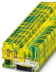
Borne de tierra de conexión por resorte, número de conexiones: 3, tipo de conexión: Conexión por resorte / conexión enchufable, 1er piso, conexión a la izquierda, sección: 0,08 mm<sup>2</sup> - 4 mm<sup>2</sup>, 1er piso, conexión a la derecha, clase de montaje: NS 35/7,5, NS 35/15, color: amarillo-verde
