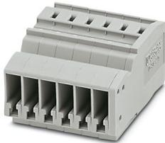
Acoplamiento COMBI, tensión nominal: 500 V, corriente nominal: 24 A, número de conexiones: 1, número de polos: 6, tipo de conexión: Conexión por resorte, Sección de dimensionamiento: 2,5 mm<sup>2</sup>, sección: 0,08 mm<sup>2</sup> - 4 mm<sup>2</sup>, clase de montaje: En placa de montaje, color: gris
