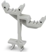
Soporte para señalización, Insertable en las bornas de conexión por resorte ST 1,5..., rotulable con UC-TM 4, UC-TMF 4, UCT-TM 4, UCT-TMF 4, ZB 4 o ZBF 4, gris, sin rotular, clase de montaje: enclavar, altura del campo de texto: 10,5 mm, anchura del campo de texto: 4 mm
