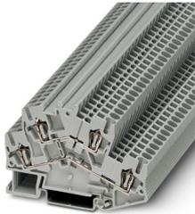
Borne de resorte de doble piso, tensión nominal: 500 V, corriente nominal: 22 A, tipo de conexión: Conexión por resorte, 1er y 2º piso, Sección de dimensionamiento: 2,5 mm<sup>2</sup>, sección: 0,08 mm<sup>2</sup> - 4 mm<sup>2</sup>, clase de montaje: NS 35/7,5, NS 35/15, color: gris
