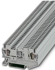
Borna seccionable, La corriente y la tensión son determinadas por el conector empleado., tensión nominal: 400 V, corriente nominal: 20 A, tipo de conexión: Conexión por resorte, Sección de dimensionamiento: 2,5 mm<sup>2</sup>, sección: 0,08 mm<sup>2</sup> - 4 mm<sup>2</sup>, montaje: NS 35/7,5, NS 35/15, color: gris
