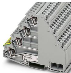
Borne para motores, cuatro pisos, tipo de conexión: conexión por resorte, sección transversal: 0,08 mm<sup>2</sup> - 6 mm<sup>2</sup>, AWG: 28 - 10, ancho: 6,2 mm, color: gris, tipo de montaje: NS 35/7,5, NS 35/15
