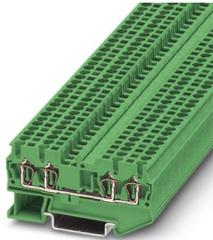
Borne de paso, tensión nominal: 800 V, corriente nominal: 24 A, número de conexiones: 4, tipo de conexión: Conexión por resorte, Sección de dimensionamiento: 2,5 mm<sup>2</sup>, sección: 0,08 mm<sup>2</sup> - 4 mm<sup>2</sup>, clase de montaje: NS 35/7,5, NS 35/15, color: verde
