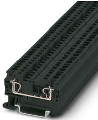
Borne de paso, tensión nominal: 800 V, corriente nominal: 32 A, número de conexiones: 2, tipo de conexión: Conexión por resorte, Sección de dimensionamiento: 4 mm<sup>2</sup>, 1er piso, sección: 0,08 mm<sup>2</sup> - 6 mm<sup>2</sup>, clase de montaje: NS 35/7,5, NS 35/15, color: negro
