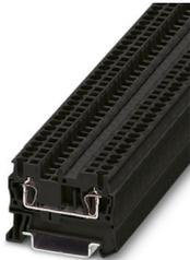
Borne de paso, tensión nominal: 800 V, corriente nominal: 24 A, número de conexiones: 2, tipo de conexión: Conexión por resorte, Sección de dimensionamiento: 2,5 mm<sup>2</sup>, sección: 0,08 mm<sup>2</sup> - 4 mm<sup>2</sup>, clase de montaje: NS 35/7,5, NS 35/15, color: negro
