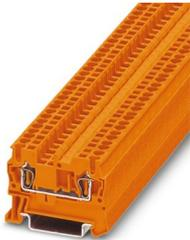
Borne de paso, tensión nominal: 800 V, corriente nominal: 24 A, número de conexiones: 2, tipo de conexión: Conexión por resorte, Sección de dimensionamiento: 2,5 mm<sup>2</sup>, sección: 0,08 mm<sup>2</sup> - 4 mm<sup>2</sup>, clase de montaje: NS 35/7,5, NS 35/15, color: naranja
