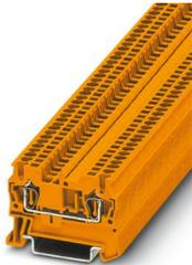
Borne de paso, tensión nominal: 500 V, corriente nominal: 17,5 A, número de conexiones: 2, tipo de conexión: Conexión por resorte, Sección de dimensionamiento: 1,5 mm<sup>2</sup>, 1er piso, sección: 0,08 mm<sup>2</sup> - 1,5 mm<sup>2</sup>, clase de montaje: NS 35/7,5, NS 35/15, color: naranja
