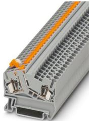
Borna interrumpible por cuchilla, tensión nominal: 400 V, corriente nominal: 20 A, 1er piso, tipo de conexión: Conexión por resorte, Sección de dimensionamiento: 2,5 mm<sup>2</sup>, sección: 0,08 mm<sup>2</sup> - 4 mm<sup>2</sup>, montaje: NS 35/7,5, NS 35/15, color: gris
