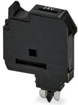
Cabeza portafusible, Antes de sustituir el fusible G, retirar la cabeza portafusible del borne de base., tensión nominal: 24 V, corriente nominal: 6,3 A, tipo de fusible: G/5 x 20, clase de montaje: Montaje por encaje, color: negro
