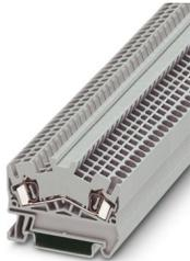
Borne de paso, tensión nominal: 800 V, corriente nominal: 24 A, número de conexiones: 2, tipo de conexión: Conexión por resorte, Sección de dimensionamiento: 2,5 mm<sup>2</sup>, 1er piso, sección: 0,08 mm<sup>2</sup> - 4 mm<sup>2</sup>, clase de montaje: NS 35/7,5, NS 35/15, color: gris
