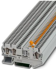
Borna interrumpible por cuchilla, tensión nominal: 400 V, corriente nominal: 20 A, tipo de conexión: Conexión por resorte, Sección de dimensionamiento: 2,5 mm<sup>2</sup>, sección: 0,08 mm<sup>2</sup> - 4 mm<sup>2</sup>, montaje: NS 35/7,5, NS 35/15, color: gris
