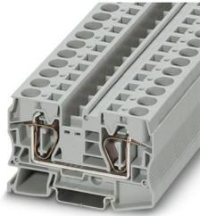
Borne de paso, tensión nominal: 1000 V, corriente nominal: 76 A, número de conexiones: 2, tipo de conexión: Conexión por resorte, Sección de dimensionamiento: 16 mm<sup>2</sup>, sección: 0,2 mm<sup>2</sup> - 25 mm<sup>2</sup>, clase de montaje: NS 35/7,5, NS 35/15, color: gris
