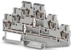
Borne multipiso, con empalmadores de potencial, tensión nominal: 500 V, corriente nominal: 20 A, número de conexiones: 6, tipo de conexión: Conexión por resorte, Sección de dimensionamiento: 2,5 mm<sup>2</sup>, 1., 2. y 3er piso, sección: 0,08 mm<sup>2</sup> - 4 mm<sup>2</sup>, clase de montaje: NS 35/7,5, NS 35/15, color: gris
