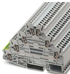
Borne para motores, cuatro pisos, con base PE, tipo de conexión: conexión por resorte, sección transversal: 0,08 mm<sup>2</sup> - 4 mm<sup>2</sup>, AWG: 28 - 12, ancho: 5,2 mm, color: gris, tipo de montaje: NS 35/7,5, NS 35/15
