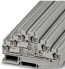
Borne multipiso, tensión nominal: 500 V, corriente nominal: 20 A, número de conexiones: 6, tipo de conexión: Conexión por resorte, Sección de dimensionamiento: 2,5 mm<sup>2</sup>, 1., 2. y 3er piso, sección: 0,08 mm<sup>2</sup> - 4 mm<sup>2</sup>, clase de montaje: NS 35/7,5, NS 35/15, color: gris
