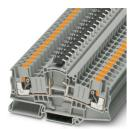
Borne para componentes, Si se alinean varios bornes para diodos sobre el carril simétrico deberá colocarse una placa distanciadora en medio., con diodo integrado P1000M, tensión nominal: 1000 V, corriente nominal: 5 A, tipo de conexión: Conexión push-in, 1er piso, Sección de dimensionamiento: 6 mm², sección: 0,5 mm² - 10 mm², color: gris
