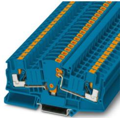
Borne interrump. para circ. medida, tensión nominal: 1000 V, corriente nominal: 30 A, número de conexiones: 2, tipo de conexión: Conexión push-in, Sección de dimensionamiento: 6 mm<sup>2</sup>, 1er piso, sección: 0,5 mm<sup>2</sup> - 10 mm<sup>2</sup>, clase de montaje: NS 35/15, NS 35/7,5, color: azul
