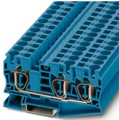
Borne de paso, tensión nominal: 1000 V, corriente nominal: 57 A, número de conexiones: 3, tipo de conexión: Conexión por resorte, Sección de dimensionamiento: 10 mm<sup>2</sup>, 1er piso, sección: 0,2 mm<sup>2</sup> - 16 mm<sup>2</sup>, clase de montaje: NS 35/7,5, NS 35/15, color: azul
