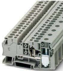
Borne colectivo de potencial, tensión nominal: 1000 V, corriente nominal: 41 A, Derivación, tipo de conexión: Conexión por resorte, Sección de dimensionamiento: 6 mm<sup>2</sup>, sección: 0,2 mm<sup>2</sup> - 10 mm<sup>2</sup>, Conexión colectiva, tipo de conexión: Conexión por tornillo, Sección de dimensionamiento: 35 mm<sup>2</sup>, sección: 1,5 mm<sup>2</sup> - 50 mm<sup>2</sup>, montaje: NS 35/7,5, NS 35/15, color: gris
